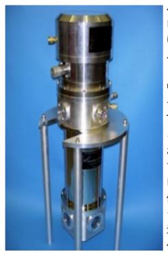
パルスチューブ冷凍機は振動も冷却時には±3ミクロン以下になっており、光学実験にも振動の影響は非常に少なくなっております。取付け方向はコールドへッド部を下側にした垂直方向への取り付けとなります。PTSHI-4シリーズはサンプルを真空中に設置し冷却するタイプで利用用途の広いクライオスタットです。窓の交換も簡単に行え、BNC、Triaxial、SMAコネクター,各種フィードスルー等いるいるな種類のコネクターをオプション用意しております。クライオスタットは実験目的に合わせて自由な設計が可能で、オプションの温度コントローラーをご使用頂ければ4K~300Kの範囲で、任意の設定温度で簡単に実験が行えます。真空シュラウドはアルミニウム製でクライオスタットが軽量になるよう設計されております。
